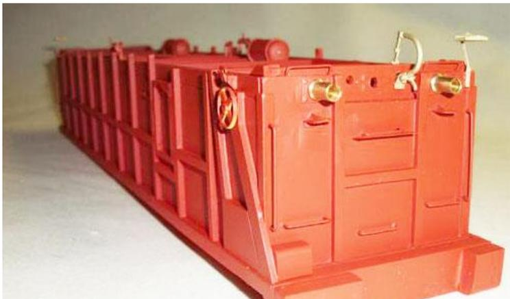
Die Entlüftung Gestänge und die Bremsschalter Gestänge werden montiert.
